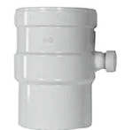
KNG 71412281 - Вертикальный комплект для сбора конденсата Позволяет собирать конденсат, который образуется в трубе отвода продуктов сгорания, предотвращая попадание конденсата в котел. Устанавливается на вертикальном участке дымохода.
